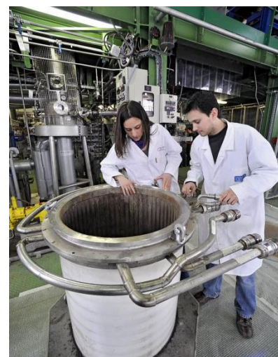
Vitrification Creuset froid CEA Marcoule © PF.Grosjean/CEA
