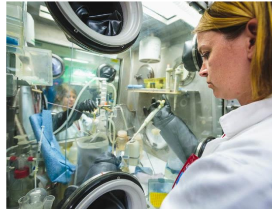
Dissolution de pastilles de MOX avant séparation par extraction liquide-liquide des constituants du combustible. @S.Le Couster/CEA
