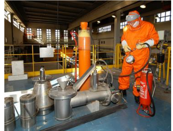
© P -F. Grosjean/CEA – Remplissage NaK d'un dispositif d'irradiation du réacteur Osiris
