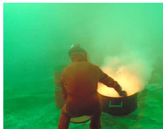
Exercice d'approche et démonstration de réactivité d'un petit feu sodium en présence d'eau - ©CEA
